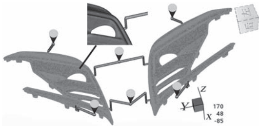
图5 镜像后模流分析模型
