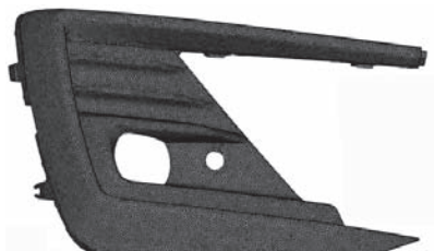
图4 Moldflow 2018 中雾灯盖板网格划分
